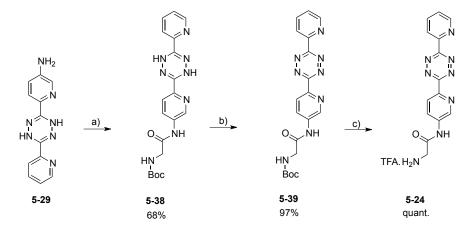
Scheme 6-29 Synthesis of H-Gly-tetrazine 5-24; a) Boc-Gly-OH, EDC.HCl, DMAP,  $CH_2Cl_2$ , rt, 20 h; b) PIDA,  $CH_2Cl_2$ , rt, 16 h; c) TFA,  $CH_2Cl_2$ , rt, 1 h.
