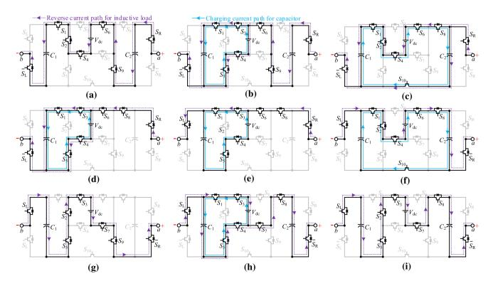
**Fig. 2** Current paths for nine output levels.  $\mathbf{a} + 4V_{dc}$ ;  $\mathbf{b} + 3V_{dc}$ ;  $\mathbf{c} + 2V_{dc}$ ;  $\mathbf{d} + V_{dc}$ ;  $\mathbf{e} \ 0$ ;  $\mathbf{f} - V_{dc}$ ;  $\mathbf{g} - 2V_{dc}$ ;  $\mathbf{h} - 3V_{dc}$ ;  $\mathbf{i} - 4V_{dc}$
