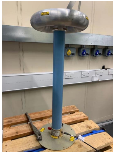
Fig. 5.13. DC voltage divider.
