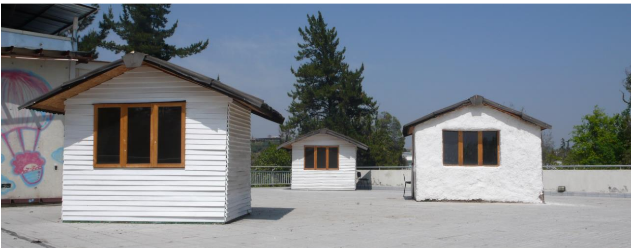
Figura 2. Celdas de prueba físicas. Mayo 2010- Noviembre 2011 (sin protección solar que fue instalada noviembre 2011)
