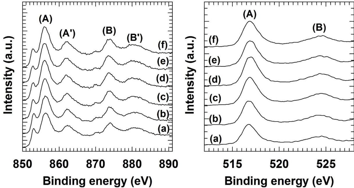
**Fig. 6.** (Left) Ni 2p and (right) V 2p core-level XPS spectra of the Ni(OH)<sub>2</sub>–POV thin films: (a) LNHV-3, (b) LNHV-2.5, (c) LNHV-2, (d) LNHV-1.5, (e) LNHV-1, and (f) LNHV-0.5.
