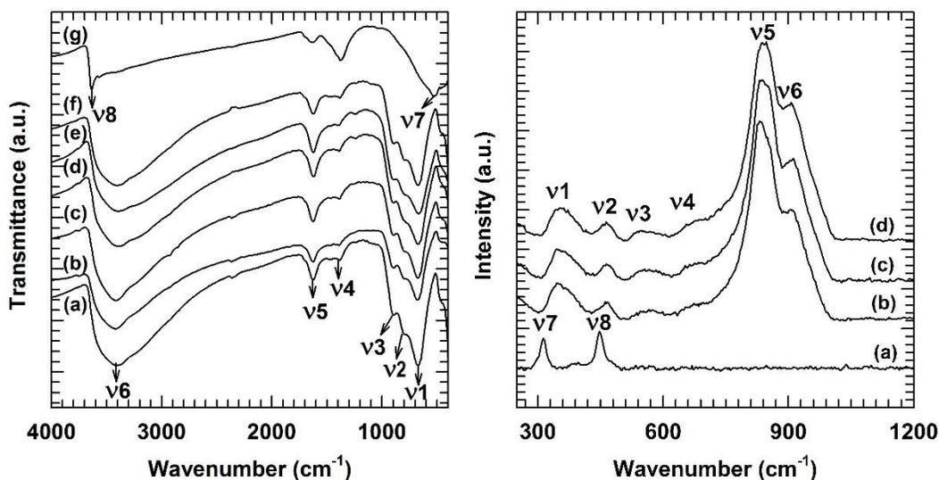
**Fig. 5.** (Left) FT-IR spectra of the Ni(OH)<sub>2</sub>-POV thin films: (a) LNHV-3, (b) LNHV-2.5, (c) LNHV-2, (d) LNHV-1.5, (e) LNHV-1, (f) LNHV-0.5, and (g) LNHV-0. (Right) Micro-Raman spectra of the Ni(OH)<sub>2</sub>-POV thin films: (a) LNHV-3, (b) LNHV-1.5, (c) LNHV-0.5, and (d) LNHV-0.
