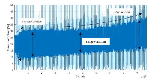
a. X-axis motor load
