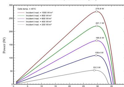
PV module: AE Solar, AE 300DGM6-60 (1500)
