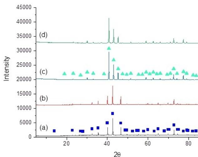
**Figure 3.** XRD patterns of: (a)  $\text{Co}_3\text{Mo}_3\text{N}$ , (b)  $\text{Co}_3\text{Mo}_{2.6}\text{W}_{0.4}\text{N}$ , (c)  $\text{Ni}_2\text{Mo}_3\text{N}$  and (d)  $\text{Ni}_2\text{Mo}_{2.8}\text{W}_{0.2}\text{N}$ . (□)  $\text{Co}_3\text{Mo}_3\text{N}$  and (△)  $\text{Ni}_2\text{Mo}_3\text{N}$ .
