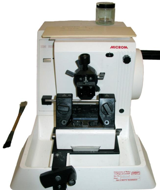
**Figure 2.12.** The Microtome (Leica, Microm HM 325).
