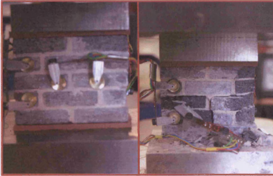
Plate 3-5: Masonry test (wallette)
