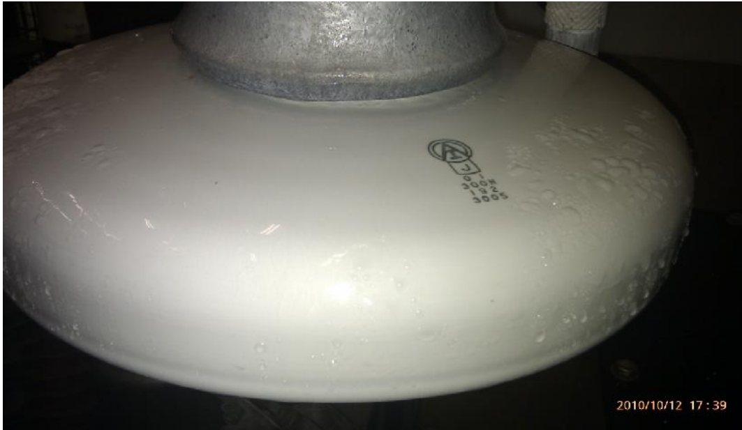
(d) Nanocoating after wet test in the fog chamber (HC6)
