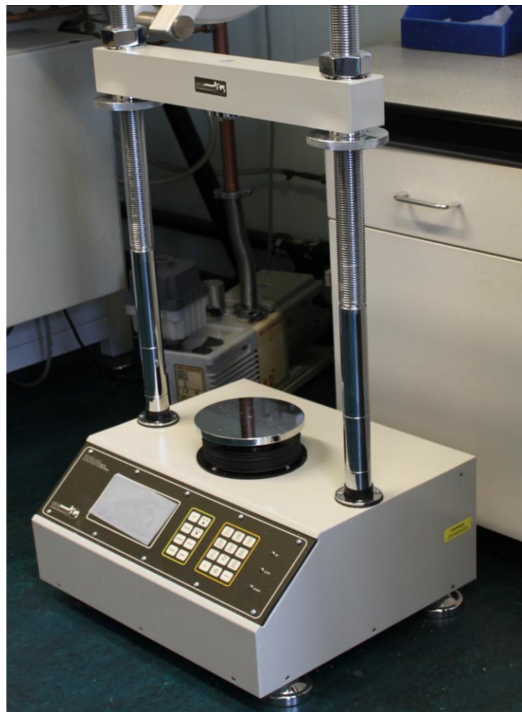
Fig. 3.25. The 50kN load frame.
